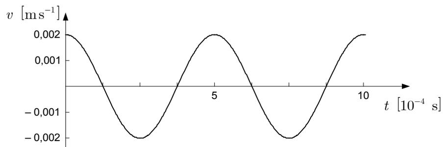
2. Tracciate il grafico che esprima la dipendenza dal tempo dello spostamento della parte centrale della membrana per due oscillazioni. Considerate che per  $t = 0$  la velocità è massima.
