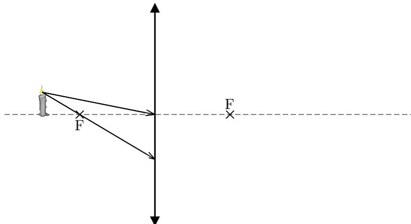
2. Tracciate nella figura come si propagano il raggio passante per il fuoco e il raggio di base dopo il passaggio attraverso la lente. Disegnate l'immagine della candela che si crea dopo la lente.
