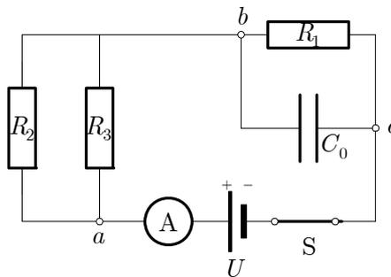
2. Namesto upornikov  $R_2$  in  $R_3$  želimo med priključka  $a$  in  $b$  priključiti en sam upornik tako, da se skupni upor vezja ne bo spremenil. Izračunajte upor tega (nadomestnega) upornika.
