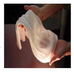
Das innovative Gewebe besteht aus speziell zusammengesetzten Fasern, die mit Kohlenstoffnanoröhren beschichtet sind. Das Trägermaterial ist dabei aus zwei unterschiedlichen Polymerstoffen aufgebaut, die in konträrere Weise \_\_24\_\_ mit Verformung reagieren. Genau auf diesem Effekt basieren die dynamischen Charakteristika des Materials. Bei Feuchtigkeit beziehungsweise Wärme verziehen sich die Fasern und ändern damit \_\_25\_\_ des Stoffes.
